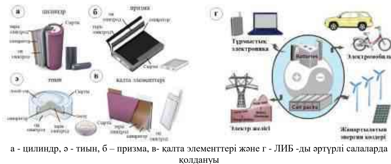
Сурет 1.3 – Қайта зарядталатын батареялардың типтік конфигурацияларының сызбанұсқалық көрінісі [39]
