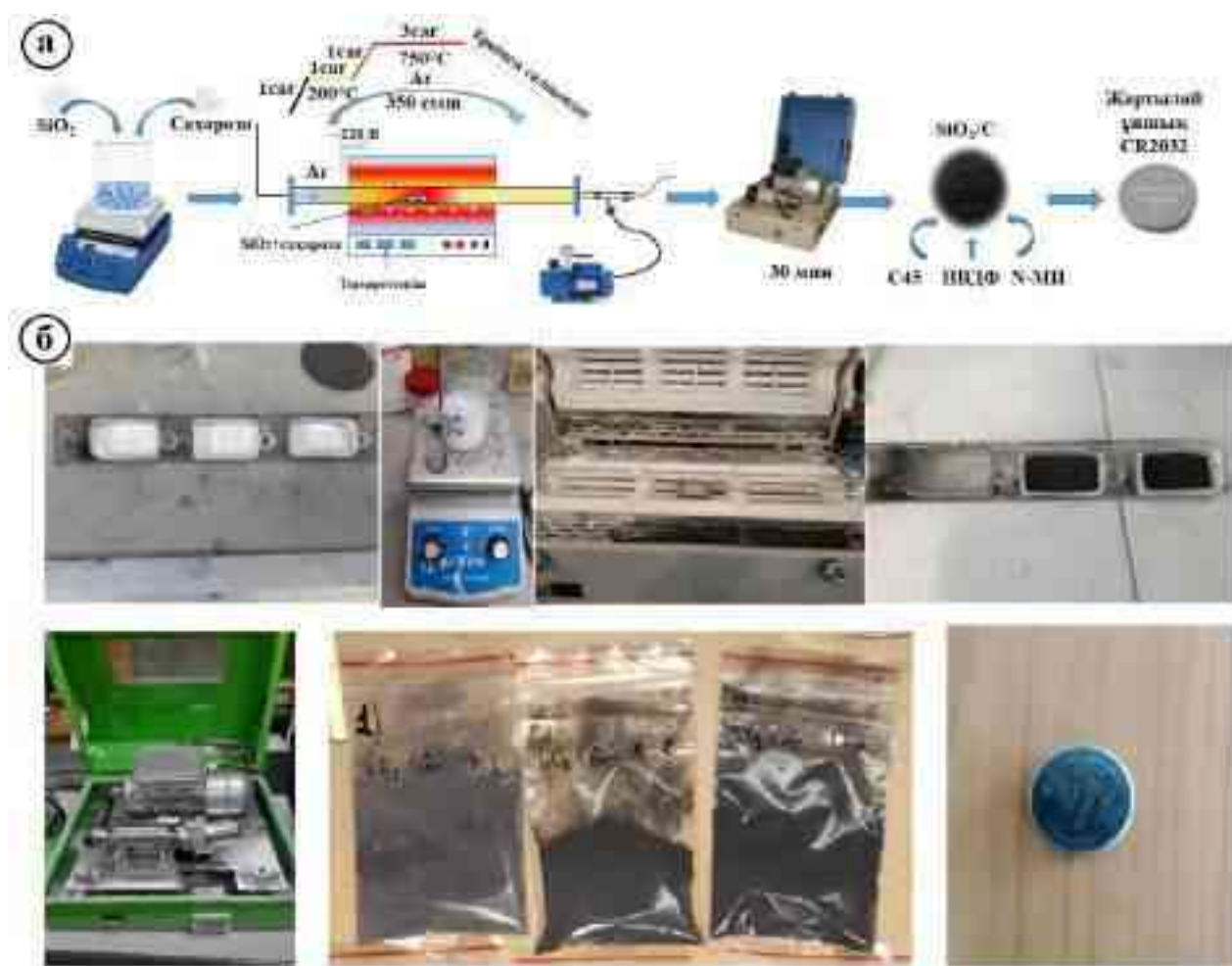
а) SiO 2 /C алу схемалық иллюстрациясы, б) зертханалық жағдайда SiO 2 /C алу кезеңдері
