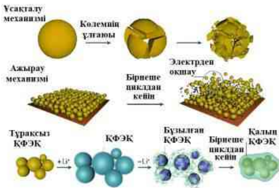
Сурет 1.9 – Кремнийдің ыдырау механизмі [94]
