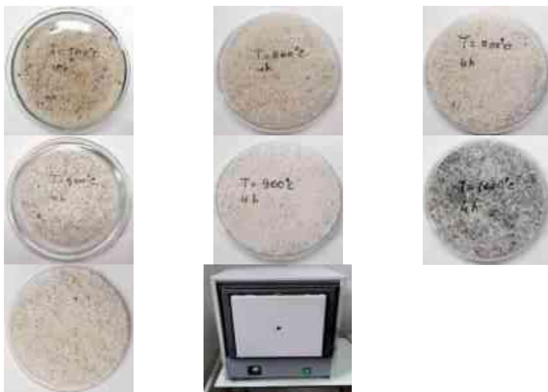
Сурет 3.6 – 500-ден-1000 °С-қа дейінгі әртүрлі температурада КҚ алынған SiO 2 фотосуреттері, муфель пешінде 4 сағат ішінде қыздыру жылдамдығы 7°С/мин
